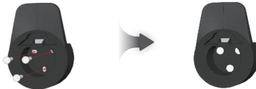
Рисунок 4.4 Схема установки держателя для коннектора
