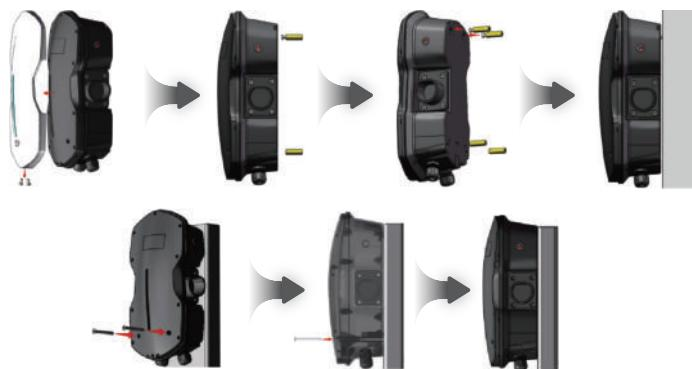
Рисунок 4.4 Крепление зарядного устройства
