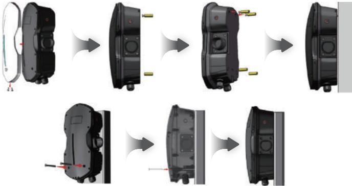
Рисунок 4.4 Крепление зарядного устройства
