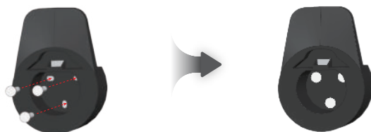
Рисунок 4.4 Схема установки держателя для коннектора
