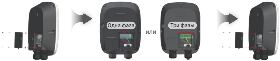
Рисунок 4.11 Подключение кабеля питания
